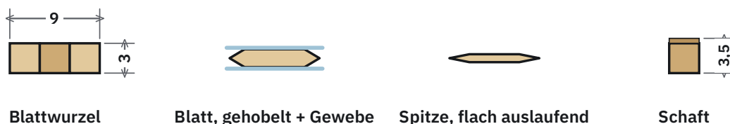
Querschnitte: an der Blattwurzel drei Leisten, in der Blattmitte gehobelt und beidseitig mit Gewebe (blau), zur Spitze flach. Schaft mit Griffleiste.
